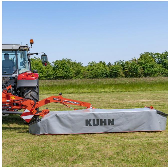
Las dos nuevas segadoras suspendidas, GMD 3515 y GMD 4015, son los últimos modelos en incorporarse a la gama de segadoras de discos KUHN especialmente diseñados para explotaciones en las que predomina la producción de forraje con anchuras de trabajo respectivas de 3,50 m y 3,95 m. Estas máquinas pueden combinarse con una segadora frontal para aumentar el rendimiento.
